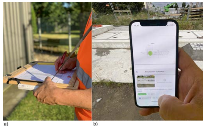
Bild 11 Schadensaufnahme: herkömmliche Methode mit Feldbuch (a), mit mobiler App ZIS Ing-Bau (b) Damage recording: conventional method with fieldbook (a), with mobile app ZIS Ing-Bau (b)
