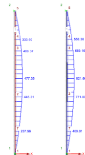
Abbildung 16 – Biegemoment um die starke Querschnittsachse nach Theorie I. Ordnung (links) und Theorie II. Ordnung (rechts)
