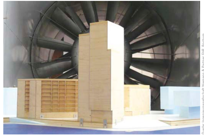
Bild 5 Modell des Gebäudekomplexes IQ im Windkanal Modell of the IQ building in the wind tunnel
